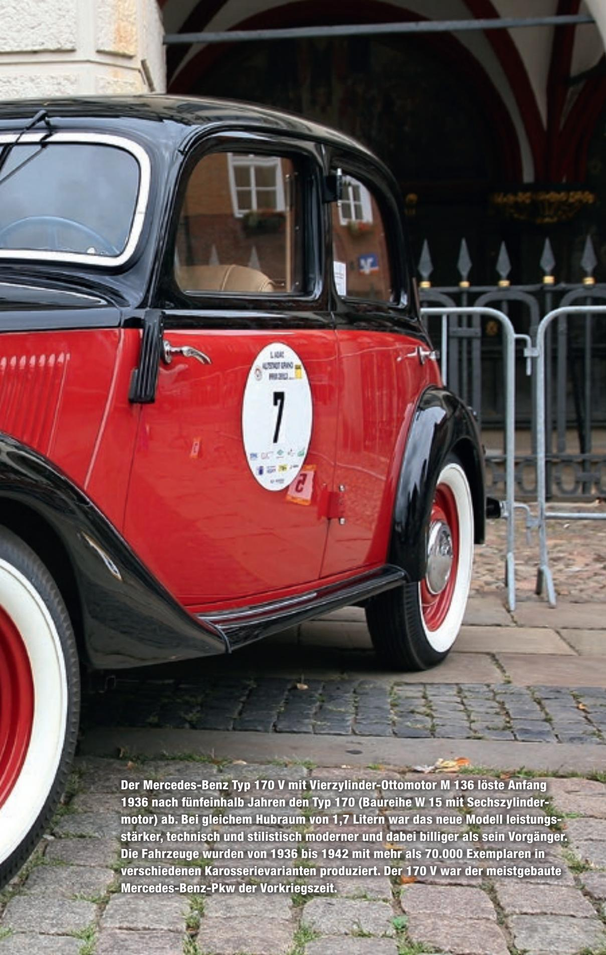
Der Mercedes-Benz Typ 170 V mit Vierzylinder-Ottomotor M 136 löste Anfang 1936 nach fünfeinhalb Jahren den Typ 170 (Baureihe W 15 mit Sechszylinder-motor) ab. Bei gleichem Hubraum von 1,7 Litern war das neue Modell leistungs-stärker, technisch und stilistisch moderner und dabei billiger als sein Vorgänger. Die Fahrzeuge wurden von 1936 bis 1942 mit mehr als 70.000 Exemplaren in verschiedenen Karosserievarianten produziert. Der 170 V war der meistgebaute Mercedes-Benz-Pkw der Vorkriegszeit.
